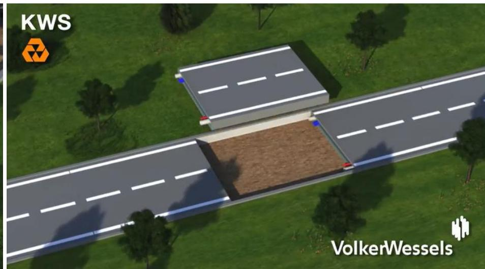
写真:ドイツVolkerWessels社HPより 道路舗装:軽量、強度・耐用年数の倍化、管・ケーブル設置、更新容易
